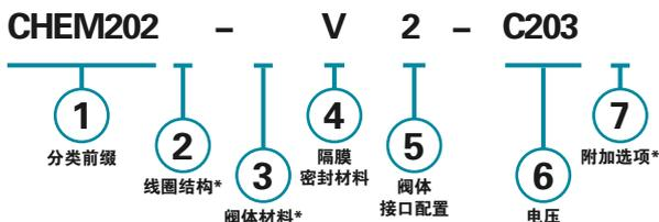
\* 空白输入表示“标准”选择（例如，快接式 0.110 扁平接头和聚氨酯 (Isoplast™)）。
